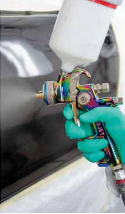
■ الاستفادة من الكهرباء الساكنة في طلاء السيارات
