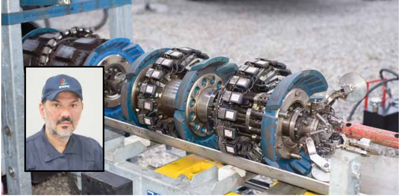
■ الكاشطة الميكانيكية أكثر الطرق فعالية في تنظيف خطوط الأنابيب... وفي الإطار أحمد العلي
