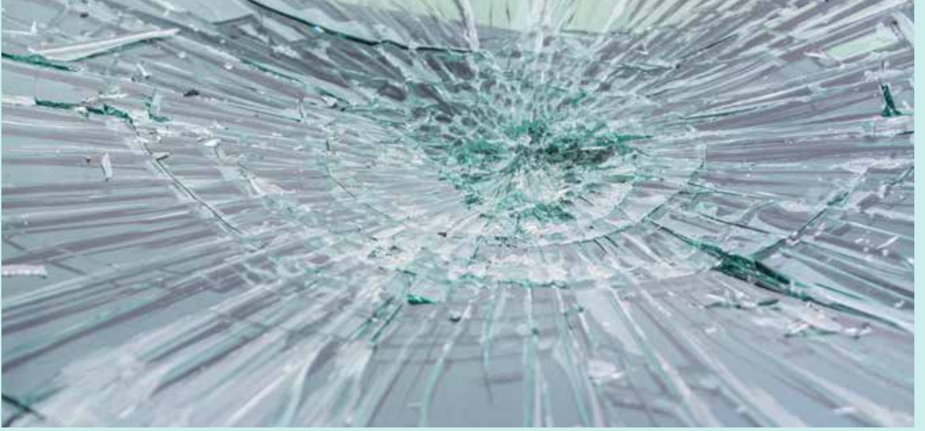
■ الزجاج الرقائقي إذا تعرض للكسر فإن شكله يكون أشبه بالشبكة العنكبوتية
