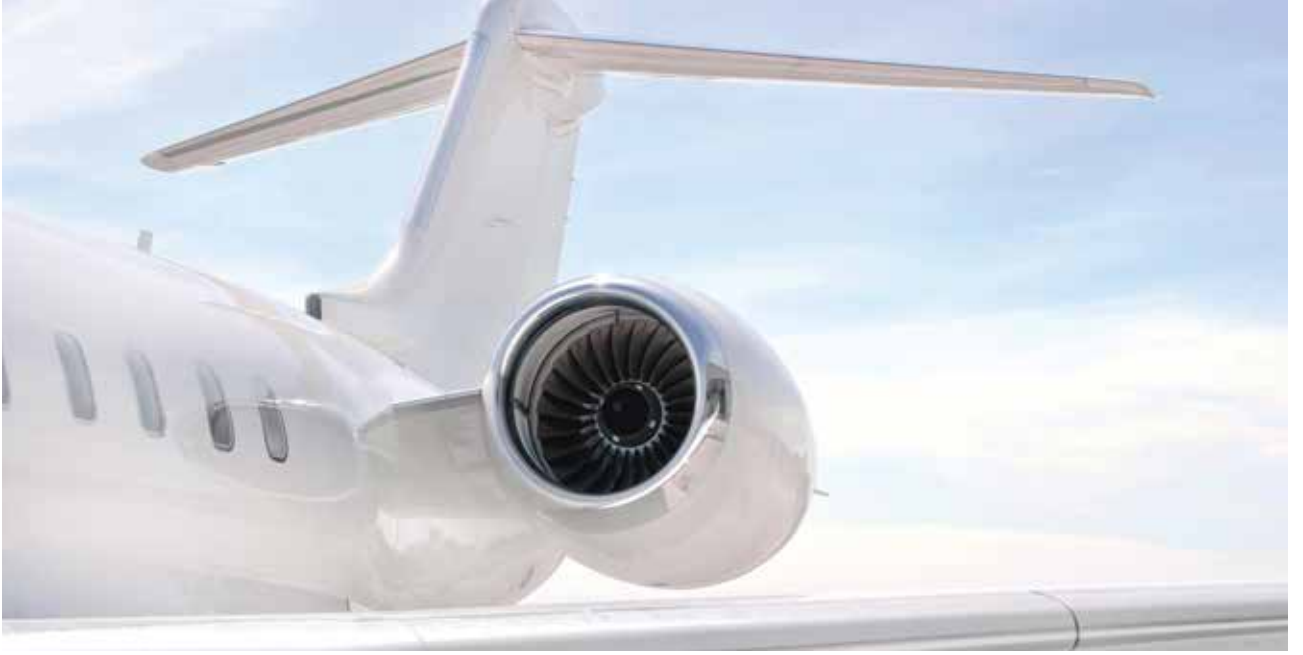
■ تستند فكرة عمل المحرك النفث على خلط الوقود بالهواء المضغوط
